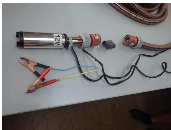
Obr. 6: Čerpadlo na prepláchnutie hadice po odbere prepojené s rýchlo-spojku
