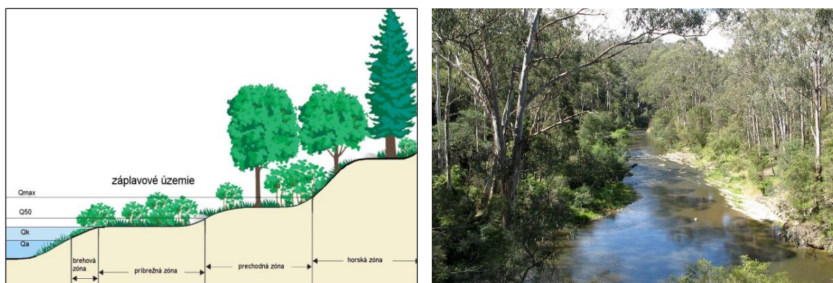
Obr.5.20 Schéma a reálny príklad (foto) rozmiestnenia vegetácie v záplavovom území
