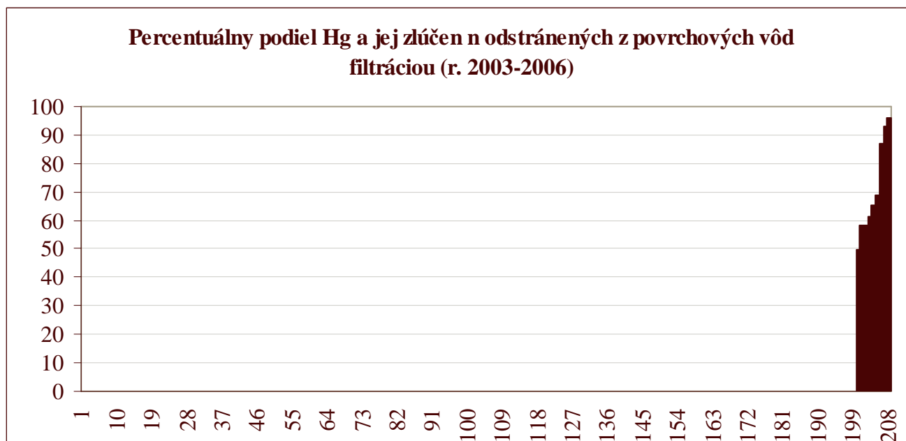
Obr. 3.17 Zhodnotenie vplyvu filtrácie na množstvo ortuti a jej zlúčenín v povrchových vodách (údaje pre Dunaj a jeho ľavostranné prítoky na území Slovenskej republiky za obdobie január 2003 až december 2006) – hodnoty 0% na osi y zodpovedajú hodnotám pod medzou stanovenia, vo výpočtoch boli hodnoty pod medzou stanovenia nahradené polovičnou hodnotou medze stanovenia
