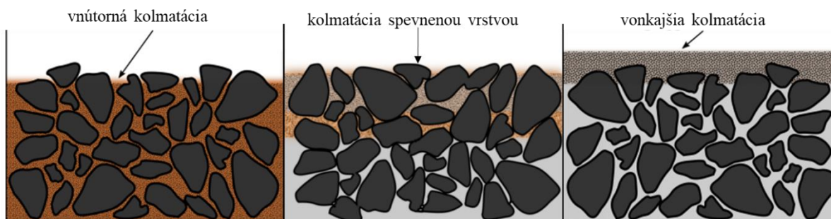
Obr. 23 Ilustračný obrázok znázorňujúci vnútornú kolmatáciu (vľavo), kolmatáciu spevnenou vrstvou (v strede) a vonkajšiu kolmatáciu (vpravo) (upravené 23 ).
