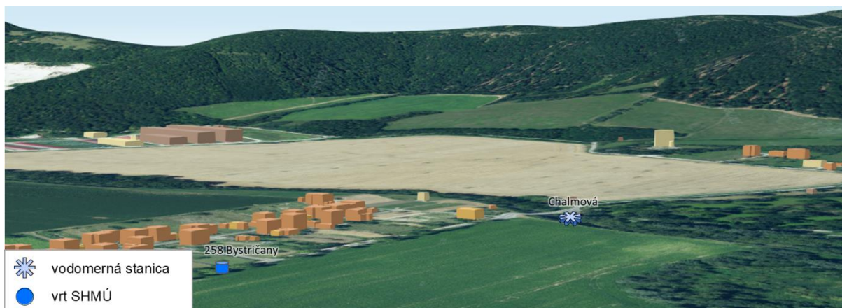
Obr. 32 3D-lokalizácia MO-PzV 258 Bystričany a vodomernej stanice 6570 Chalmová vzdialených od seba cca 365 m (zdroj: zbgis.geolog.sk).
